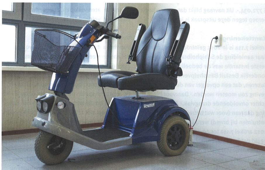
Het stallen en opladen van scootmobiel op de vluchtroute vergroot de ontruimingstijd.
